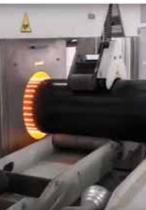
Formatura del bicchiere sulla guarnizione POWERLOCK
