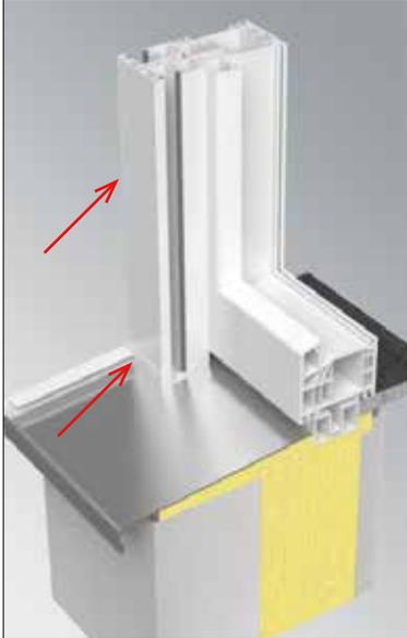
1. Rollladenbauteile aus Kunststoff sind auf Grund ihrer Materialeigenschaften thermisch verformbar. Einwirkungen von hohen Temperaturen und gleichzeitiger Gewichts- oder Druckbelastung können zu dauerhaften Verformungen führen. Die äußeren Putzanschlüsse dürfen daher keinen Druck auf die Rollladenführungsschienen ausüben.
